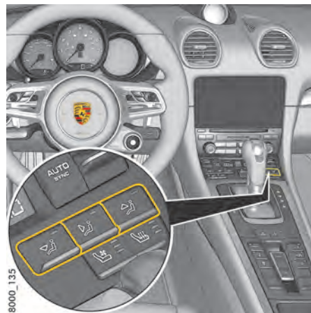
図 21: 送風口切り替えボタン
