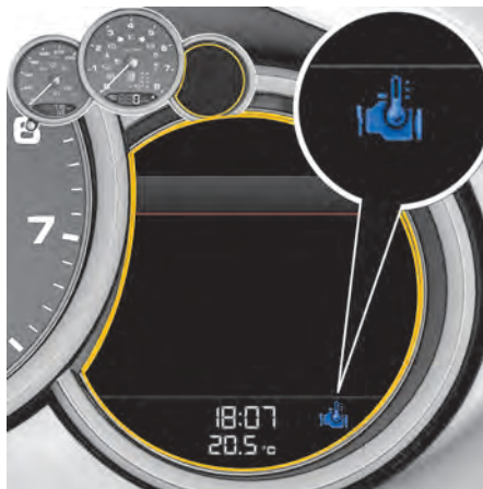
図 44: 触媒コンバーターの加熱フェーズ用シンボル
