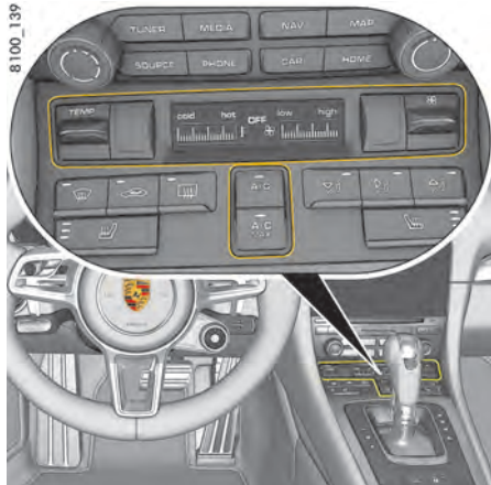
図 28: エアコンコントロールパネル
