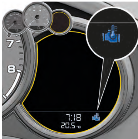
図 31：触媒コンバーターの加熱フェーズ用シンボル
