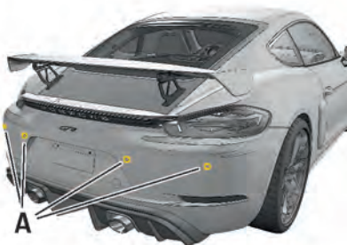
図 145：距離測定用超音波センサー
