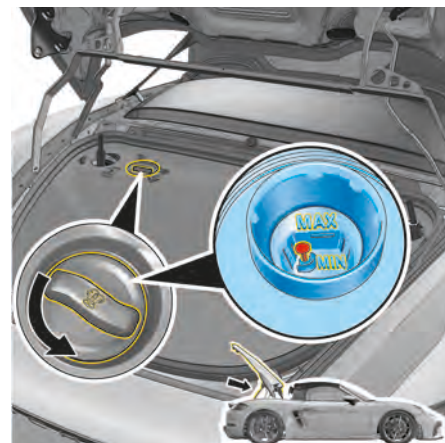
図 39：718 Spyderのクーラントリザーバータンク
