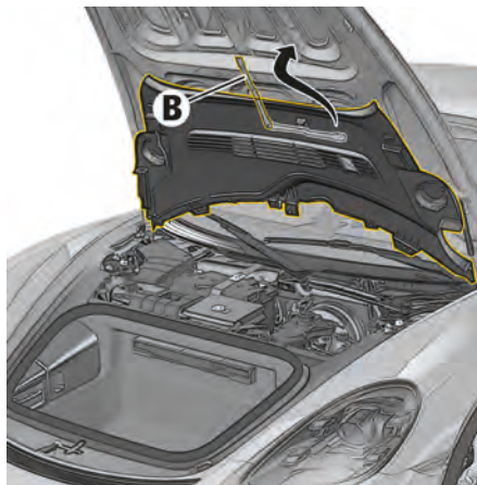
図 213：プラスチックカバーの取り付け
