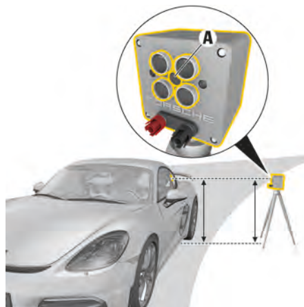
図 204：送信機の設置
