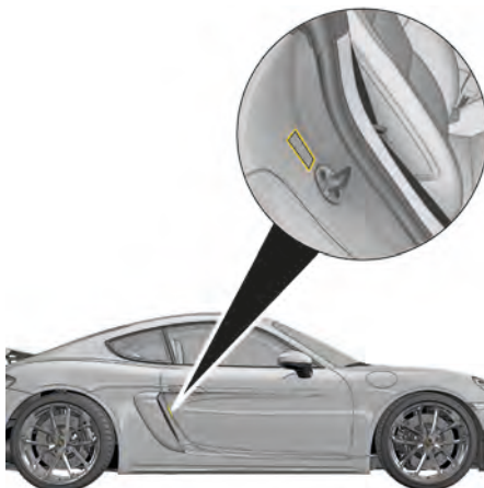
図 233：ビークルプレートの記載箇所
