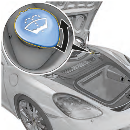
図 4：フロントウィンドウおよびヘッドライト用ウォッシャー液タンク
