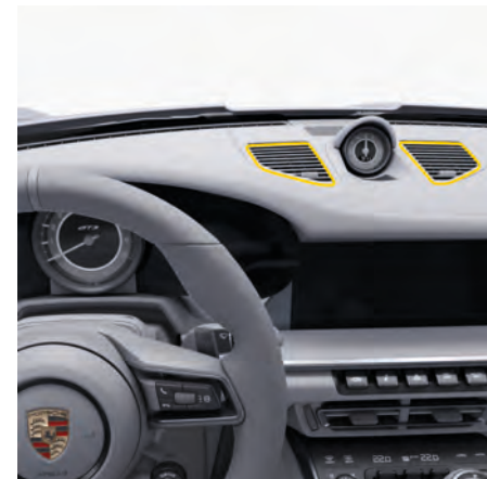
図. 47: アッパー換気パネルの調節
