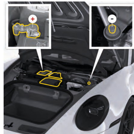
図. 142: リチウム バッテリー端子
