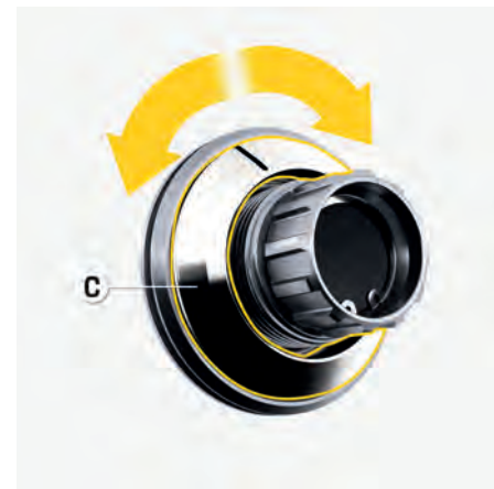
図. 161: コーンリングの点検
