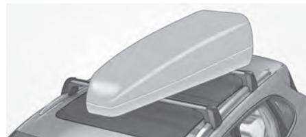
ポルシェのハンドリング特性は積載荷重によって変化します。ルーフトランスポートシステムを使用しているときは、空気抵抗も大きくなります。
