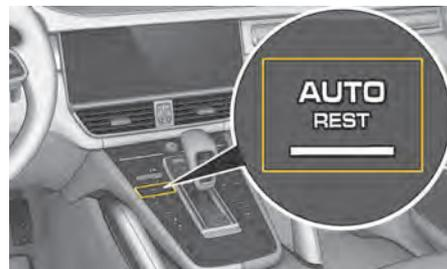
図. 56 REST モードの作動および停止
