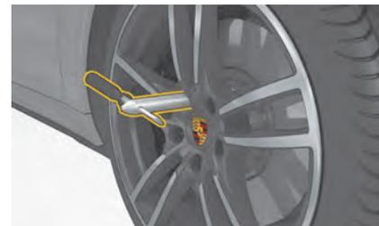
図. 235 PCCB 非装備車には、組み付け補助工具を1つねじ込みます
