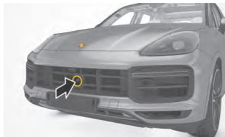
図. 81 レーダーセンサーの取り付け位置
