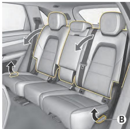
図. 67 外側のリヤシートバックレストを前方に倒す
