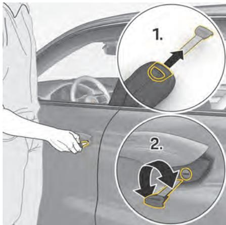
図. 29 緊急ロック解除 / 緊急ロックの実行
