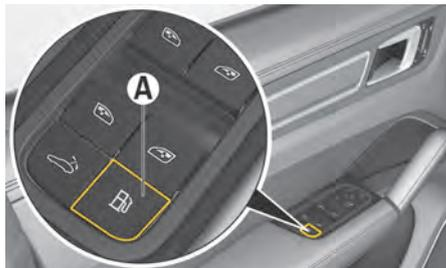
図. 244 ボタン A：燃料タンクベンチレーションの開始およびフィルターフラップの解除 (E ハイブリッド車)
