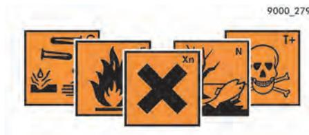
燃料だけでなく、エンジンオイル、トランスミッションオイル、AdBlue®、バッテリー液、クーラントおよびブレーキフルードも人体には有害です。
