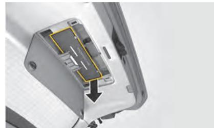
図. 193 応急処置セットと停止表示板の取り外し(国別仕様による)
