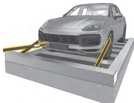
図. 220 車両をフラットベッドに固定する
