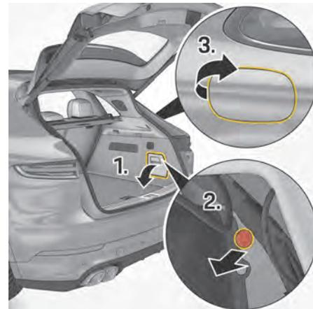
図. 247 緊急時のフィルターフラップのロック解除
