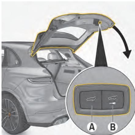
図. 18 リヤリッドのトリムパネルのボタン
