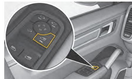
図. 15 キーによるウィンドウの開閉
