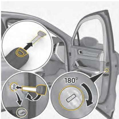
図. 30 助手席ドアの緊急ロックの実行
