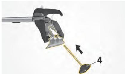
図. 184 キャリアサポートでファスニングブラケットを固定します。
