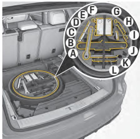
図. 195 車載工具 (コラプシブルスペア ホイールを含む) の取り外し
