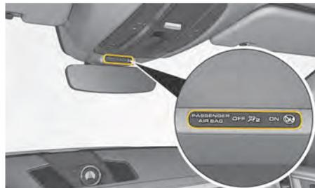
図. 40 助手席エアバッグ OFF/ON インジケータ
