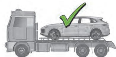
けん引または押しがけによる始動により、車両に重大な損傷を与えるリスクがあります。
