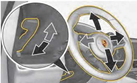
図. 57 ステアリングホイール調節用ロックレバー
