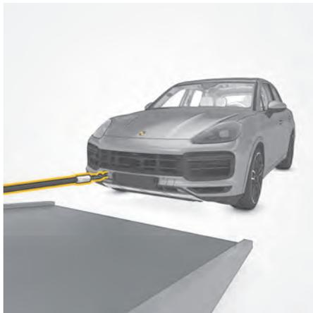
図. 219 車両をフラットベッドに載せる
