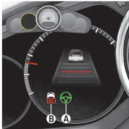
図. 91 速度 & アシスト機能ディスプレイのアクティブレーンキープ
