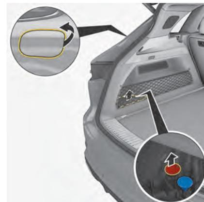
図. 228 充電ポートリッドの緊急解除の実行
