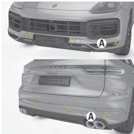
図. 116 距離測定用超音波センサー
