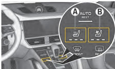
図.73 フロントシートヒーター/フロントシートベンチレーターのON/OFFの切り替え
