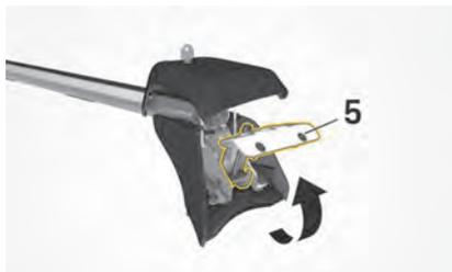
図. 185 ファスニングブラケットを上方向に回転させ、キャリアサポートにはめ込みます。
