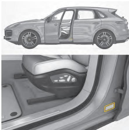
図. 254 タイヤ空気圧プレート固定ポイント
