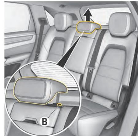
図. 72 中央リヤシートのヘッドレストの取り外し
