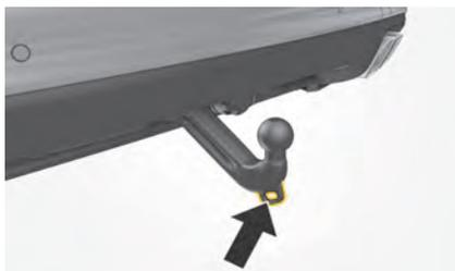
図. 174 ブ레이크アウェイ ケーブルのファスニングラグへの締結
