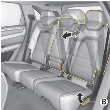
図. 66 リヤシートバックレストの角度調節
