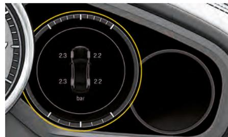
タイヤ空気圧が極端に低いまたは高いと、タイヤおよびホイールに修復不可能な損傷が発生するだけでなく、制動距離が長くなり、事故を起こす危険が大幅に高まります。タイヤ空気圧が低すぎる場合は、燃費が著しく低下する恐れがあります。
