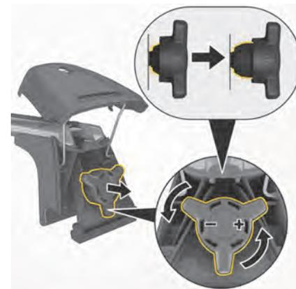
図. 179 ファスニングスクリューを取り外して、反時計方向に回します
