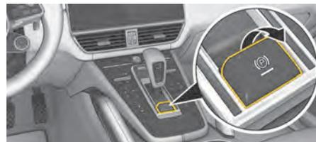
通常のフットブレーキが故障している場合などは、電動パーキングブレーキを使用してフルブレーキをかけることができます。
