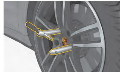
図. 236 PCCB 装備車には、組み付け補助工具を2つねじ込みます
