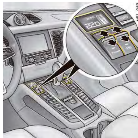
温度設定および送風量調節（フロント・コントロール・パネル）
