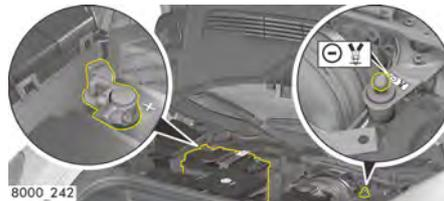
不適切なジャンパー ケーブルを使用したり、不適切な始動手順を行ったりすると、回路がショートして火災が発生する恐れがあります。ジャンパー ケーブルによるエンジンの始動中に、爆発性の高い電解質のガスがバッテリー周囲で発生します。
