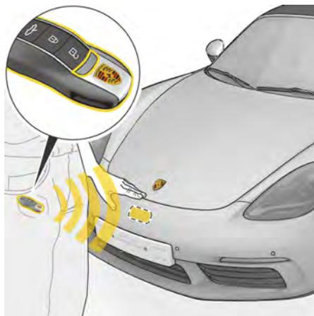
図219：ポルシェエントリー&ドライブでフロントラゲッジコンパートメントリッドを開く
