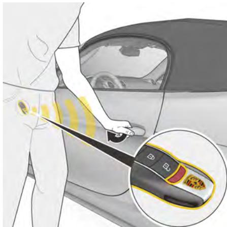
図111: ポルシェエントリー&ドライブによるドアのロック解除
