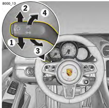
図205：方向指示灯およびハイビーム操作レバー
