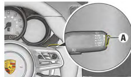
図164：レインセンサー/間欠作動感度のスイッチ (A)
