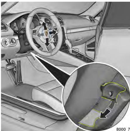
図91：ステアリングホイール調整用ロックレバー
