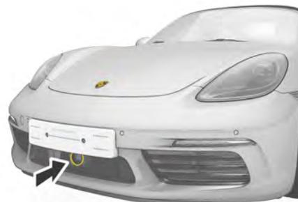
図1: レーダーセンサーの取り付け位置
