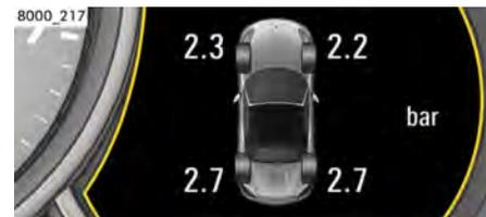
タイヤ空気圧が低いまたは高いと、タイヤおよびホイールに修復不可能な損傷を与えるばかりか、制動距離が長くなったり、事故を起こす危険が大幅に高まります。タイヤ空気圧が低すぎる場合は、燃費が著しく低下する恐れがあります。
