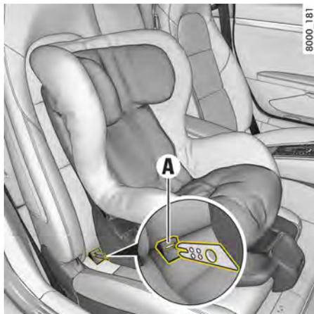
図131：ISOFIX システム付きチャイルドシートの取り付け
