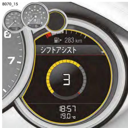
図189：ギヤシフトアシストの例
