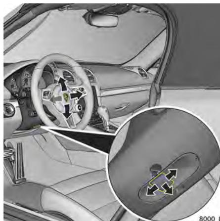
図92：ステアリングホイール調整用コントロールスイッチ
