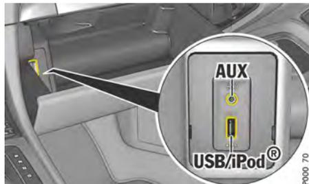
図182：グローブボックスのUSB (タイプ A) および汎用オーディオ (AUX) ポート (装備仕様による)
