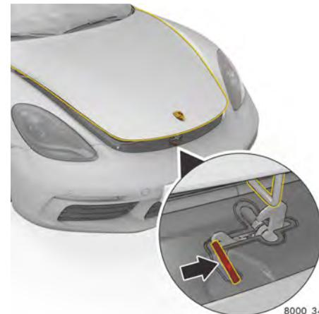
図217：フロントラゲッジコンパートメントリッドのロック解除
