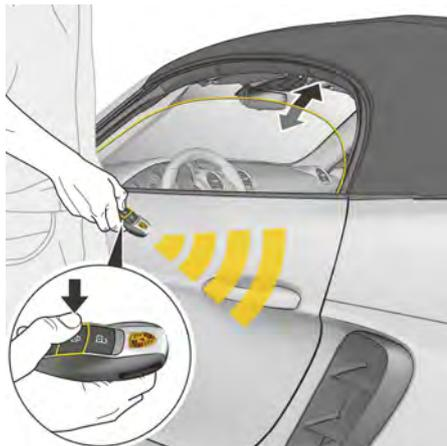
図16：キーによるサイドウィンドウの開閉
