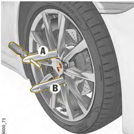
図124：組み付け補助工具
