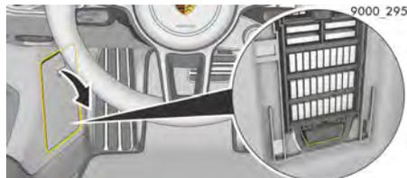
故障診断用ソケットはポルシェ正規販売店で診断装置を接続するためのものです。イグニッションをオフにした状態で、外部装置(ナビゲーションユニット、ヘッドアップディスプレイなど)を故障診断用ソケットに接続した場合、車両システムの機能に支障をきたしたり、バッテリーが完全に消耗し、損傷する(完全に上がる)可能性があります。外部機器またはケーブルは、制動時またはカーブ走行時にペダル作動の障害となったり、ペダル間に挟まったりする可能性があります。
