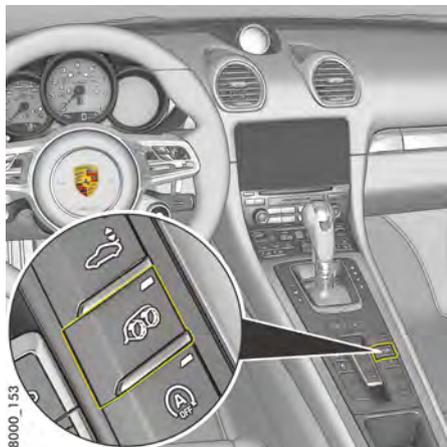
図94：センターコンソールのスポーツエキゾーストシステム操作ボタン
