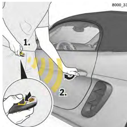
図110：キーによるドアのロック解除
