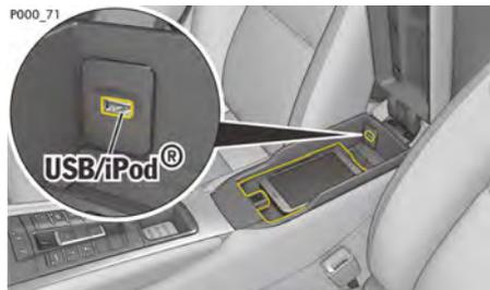
図183：センターコンソールのUSBポート (タイプ A)
