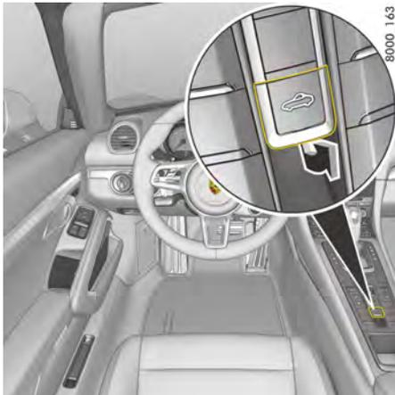
図63：ボタンによるコンバーチブルトップの閉操作
