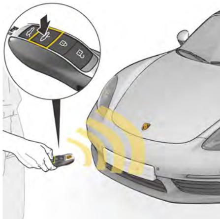
図218：キーでラゲッジコンパートメントリッドを開く
