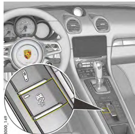
図184：センターコンソールの PSM OFF ボタン
