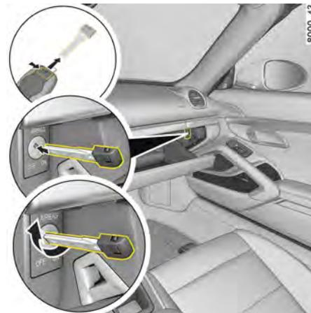
図128：助手席エアバッグのON/OFF
