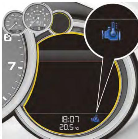
図43：触媒コンバーターの加熱フェーズ中の表示
