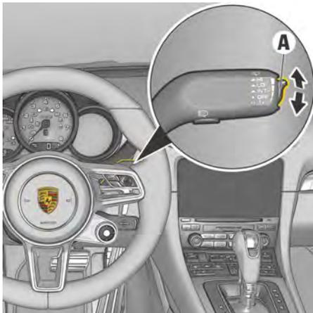
図166：レインセンサー / 間欠作動感度の切り替えスイッチ
