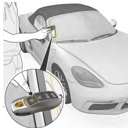
図115：リモコンが故障した場合の緊急解除
