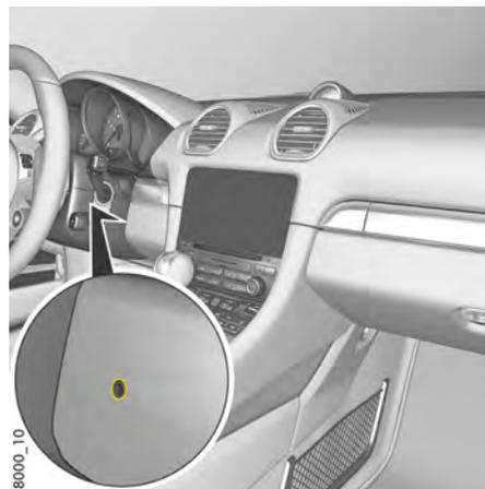
図28：エアコン用車内温度センサー
