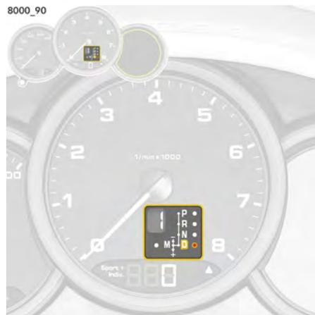
図139：セレクターレバーポジションインジケーターおよびギヤポジションインジケーター
