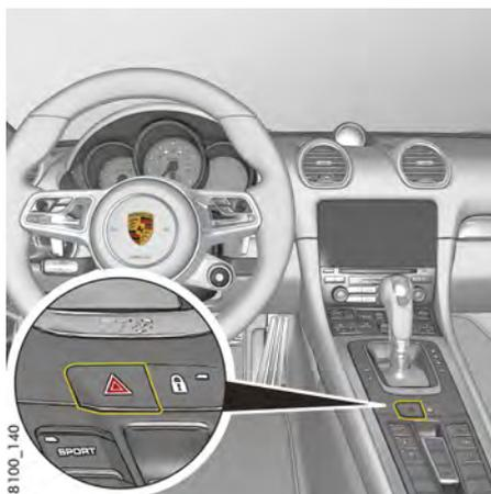
図206：センターコンソールのハザードライトボタン
