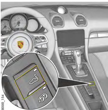
図226：センターコンソールのリヤスポイラー操作ボタン
