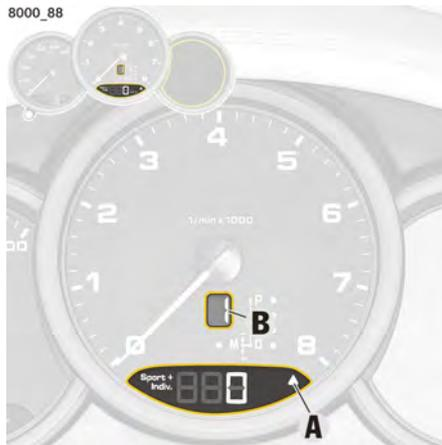
図137：シフトアップインジケータAおよびギヤインジケータB
