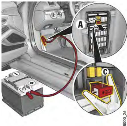
図221：ラゲッジコンパートメントリッドの緊急解除 - プラス端子の接続
