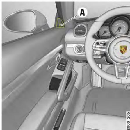
図227：ドアミラー取付部フィニッシャーの警告インジケーター A
