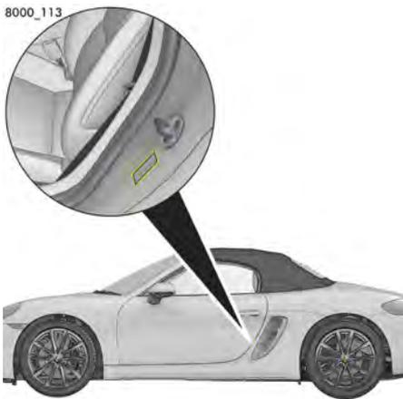
図117: ドアシル(ドア開口部)のタイヤ空気圧プレート
