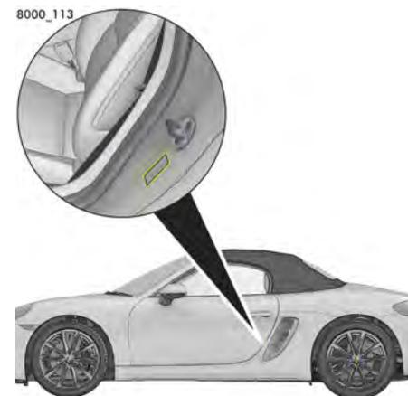
図240：タイヤ空気圧プレート固定位置
