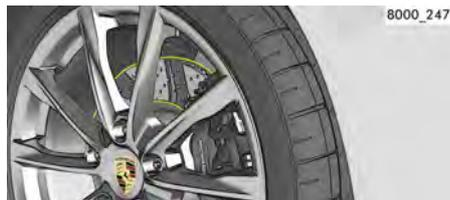
新品のブレーキパッドおよびブレーキディスクも、エンジンと同様に慣らし運転が必要です。新しい部品を装着してから最初の数百kmは、ブレーキ性能を完全には発揮できません。多少ブレーキの効きが弱くなるため、強めにブレーキを踏む必要があります。
