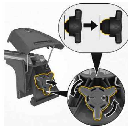
図 215 : ファスニング スクリューを取り外して、反時計方向に回します。
