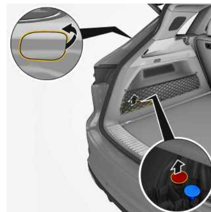
図 100: 車両プラグ (DVD チェンジャー装備車) の緊急解除の実施
