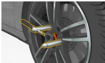
図 108 : PCCB 装備車には、組み付け補助工具を 2 つねじ込みます
