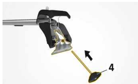
図 220: キャリア サポートでファスニング ブラケットを固定します。
