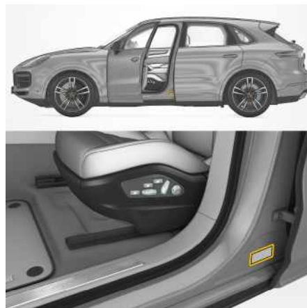
図 246 : タイヤ空気圧プレート固定位置
