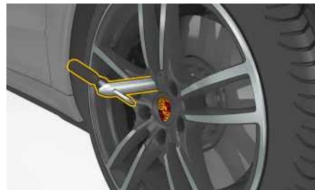
図 107 : PCCB 非装備車には、組み付け補助工具を 1 つねじ込みます
