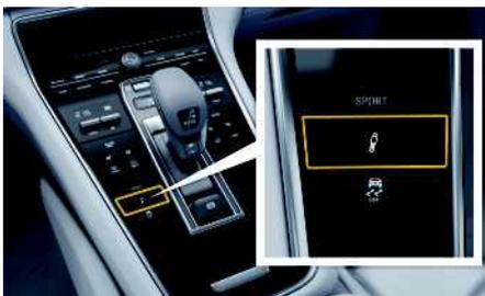
図 31 : センター コンソールの PASM ボタンを使ったシャーシ設定の選択
