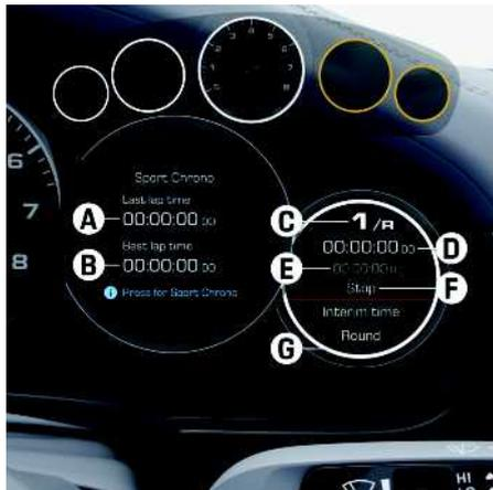
図 69 : インstrument パネルのストップウォッチ
