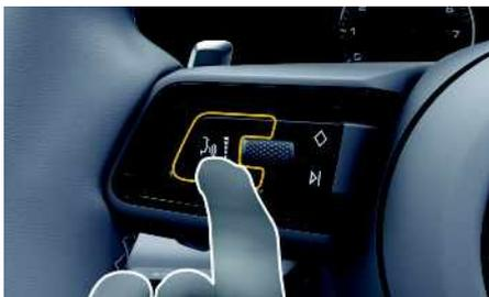
図 151 : ステアリング ホイールの ボイス コントロール ボタン
