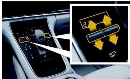
図 23：フロントの温度および風量の設定
