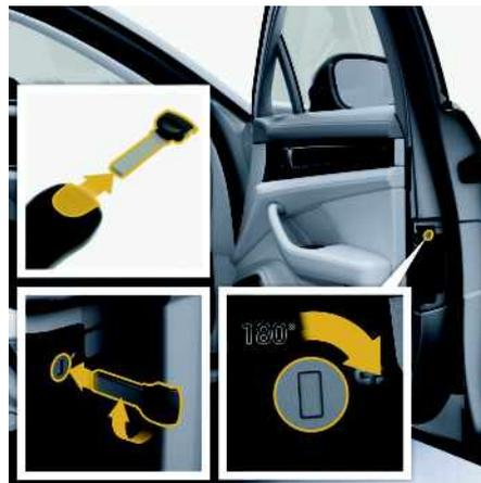
図 82 : 助手席ドアの緊急ロックの実行
