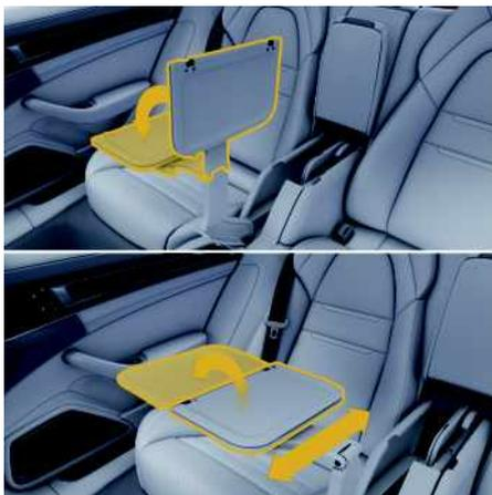
図 88 : 格納式テーブルの調整
