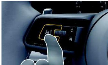
図 225 : マルチファンクションステアリングホイールのボイスコントロールボタン
