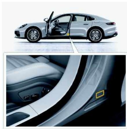
図 231 : タイヤ空気圧プレート固定ポイント
