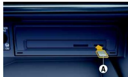
図 124：外付けSIMカードの挿入および取り出し
