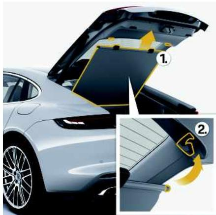
図 186：格納式ラゲッジコンパートメントカバーの引き出し
