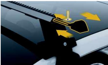
図 210 : カバー トリムをサイズに合わせて切り、押し込む
