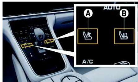
図 57：フロントシートヒーター / フロントシートベンチレーターの ON/OFF の切り替え
