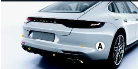
図 134 : 距離測定用超音波センサー
