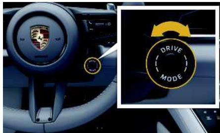
図 228：ステアリングホイールのモードスイッチ
