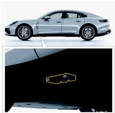
図 61：フロント側のリフティング プラットフォームおよびジャッキのジャッキアップポイント
