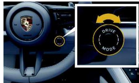
図 131 : ステアリングホイールのモードスイッチ
