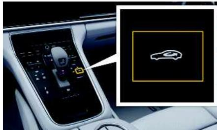
図 26: 内気循環モードをON/OFFにする
