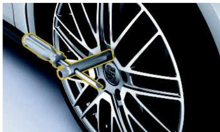
図 98：PCCB 非装備車には、組み付け補助工具を 1 つねじ込みます
