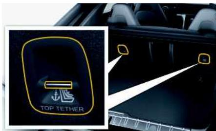
図 109 : リヤシート 2 席装備車 : ISOFIX アンカーポイント (トップテザー) の固定位置
