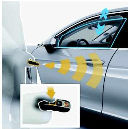
図15: キーによるウィンドウの開閉
