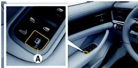
図 46：ボタン A：燃料タンク ベンチレーションの開始およびフィルター フラップの解除
