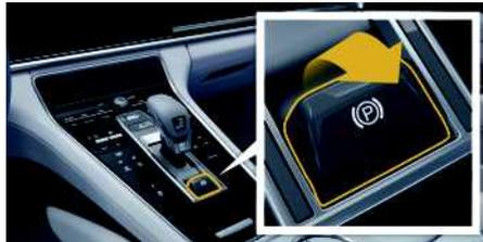
通常のフットブレーキが故障している場合などは、電動パーキングブレーキを使用してフルブレーキをかけることができます。
