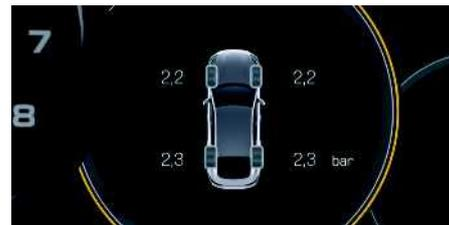
極端に低いまたは高いタイヤ空気圧は、タイヤおよびホイールに修復不可能な損傷を与えるだけでなく、制動距離が長くなり、事故を起こす危険が大幅に高まります。タイヤ空気圧が低すぎる場合は、燃費が著しく低下する恐れがあります。
