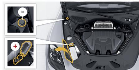
不適切なジャンパー ケーブルを使用して車両を始動したり、ジャンパー ケーブルによる始動を適切に行わなかった場合は、回路がショートし火災が発生する恐れがあります。ジャンパー ケーブルによるエンジンの始動中に、爆発性の高い電解質のガスがバッテリー周囲で発生することがあります。
