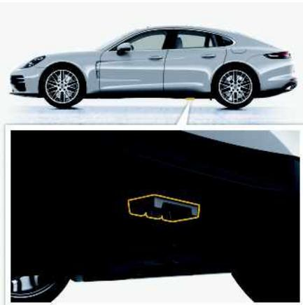
図 62：リヤ側のリフティング プラットフォームおよびジャッキのジャッキアップポイント
