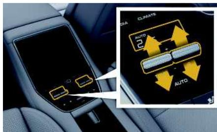
図 24：リアの温度および風量の設定 (4 ゾーン エアコン)
