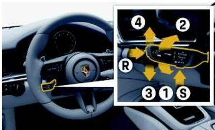
図 213 : レーンキープアシストの操作
