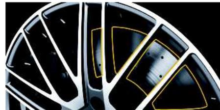
大雨の中で水たまりを走行する場合や洗車場を出た後は、ブレーキ内に水が浸入する可能性があり、ブレーキの反応が遅れたり、ブレーキ ペダルを踏み込む時に普通以上に力が必要になったりすることがあります。さらに、冬季の路面を長距離にわたって走行すると、ブレーキ ディスクやパッドに被膜ができて摩擦力が大幅に低下し、ブレーキ性能も低下することがあります。
