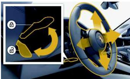
図 64 : ステアリングホイールの手動調節用レバー
