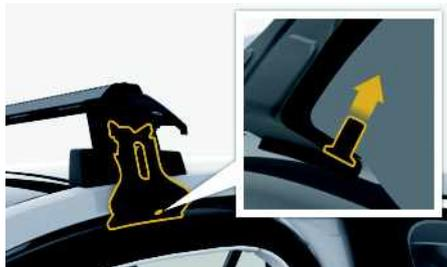
図 209 : ロック ピンの挿入
