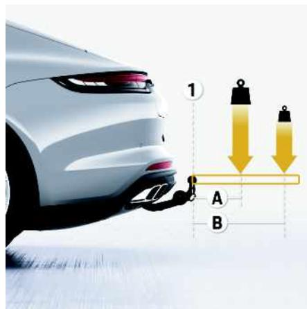
図 121：アタッチメントおよびアクセサリーの荷重配分模式図
