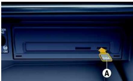
図 154 : 外部 SIM カードの挿入および取り出し
