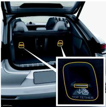
図 110 : リヤシート 3 席装備車 : ISOFIX アンカーポイント (トップテザー) の固定位置
