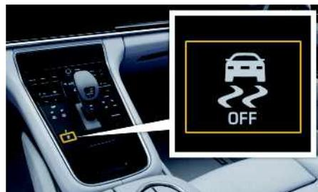
図 226 : センターコンソールのPSM OFF ボタン
