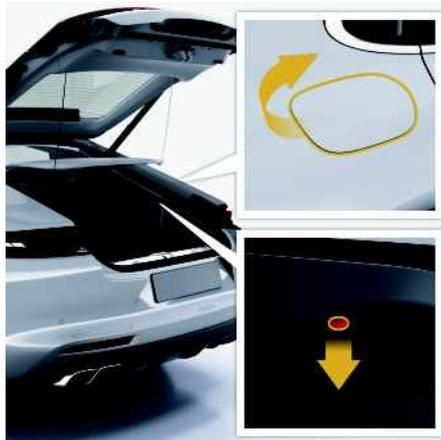
図 49 : 緊急時のフィルター フラップのロック解除
