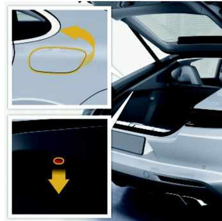
図 92：充電ポートリッド緊急解除の実施
