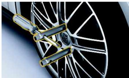
図 99：PCCB 装備車には、組み付け補助工具を 2 つねじ込みます
