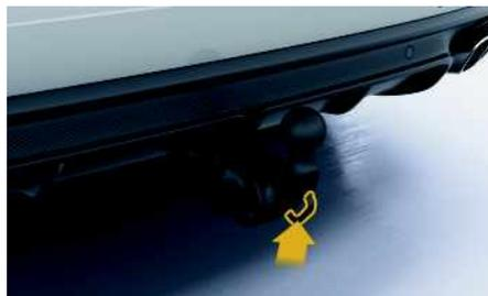
図 120：締め付けラグのボールヒッチへの取り付け
