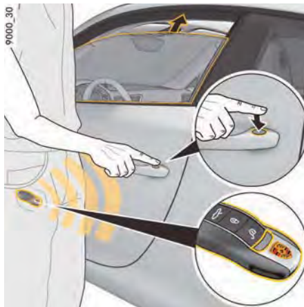
図17: ドア・ハンドルのタッチ・センサーでウィンドウを閉じる (ポルシェ・エントリー&ドライブ装備車)
