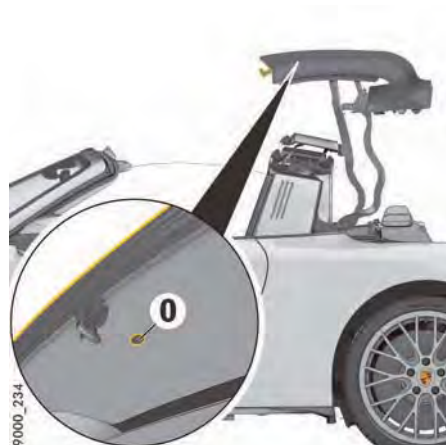
図141: ルーフ・キャッチ緊急操作用アクセス・ポイントからプラグの取り外し
