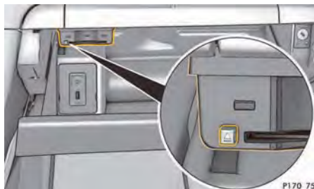
図183: グローブ・ボックス内のETCカード・リーダー
