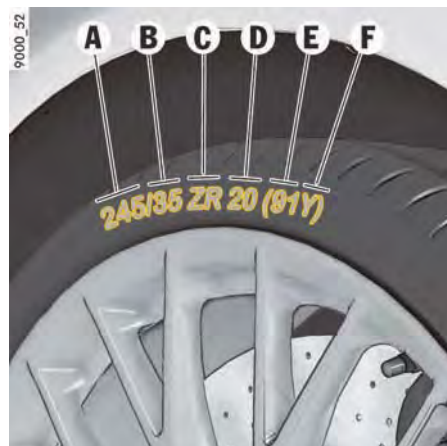
図126: ラジアル・タイヤの見方
