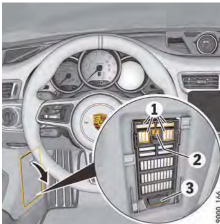
図191: 左側足元のヒューズ・ボックスにあるエレメント
