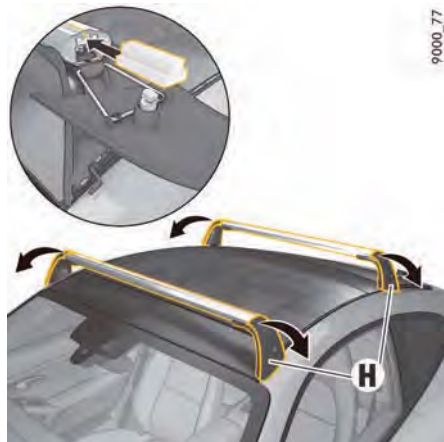
図264: 積載機器の挿入
