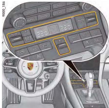
図19: エアコン・コントロール・パネル
