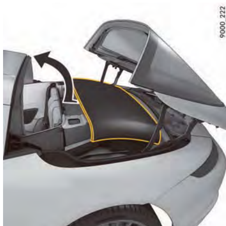
図140: コンバーチブル・トップ・エレメントの閉操作
