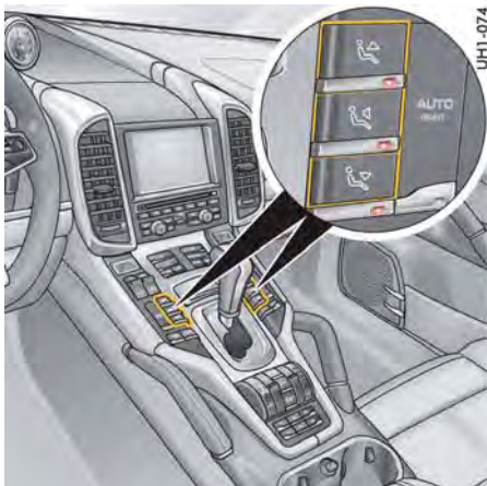
送風口の切り替え (フロント・コントロール・パネル)
