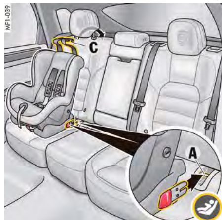
図136: ISOFIXリテーニング・ラグが装備されているチャイルド・シートのリヤ・シートへの取り付け
