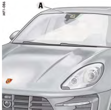
図259: カメラの取り付け位置
