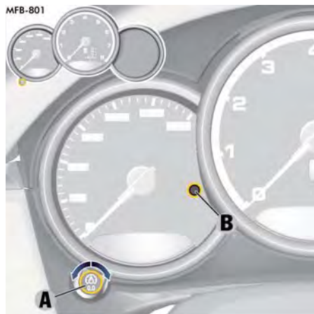
図11: 照明ボタンとライト・センサー
