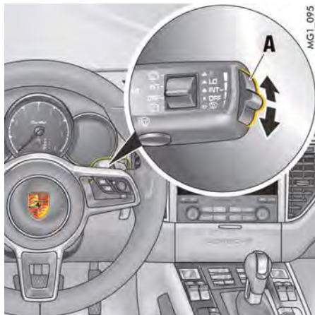
図187: レイン・センサー / 間欠作動感度の切り替えスイッチ
