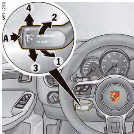
図65: クルーズ・コントロール操作レバー
