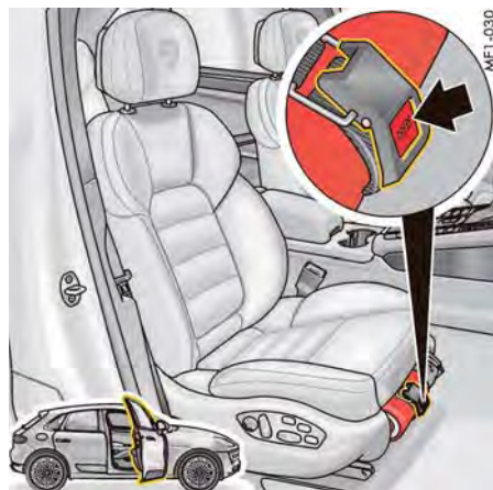
図90: 助手席シートの下の消火器
