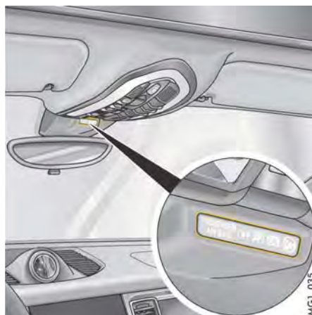
図23: 助手席エアバッグ オフ/オン インジケータ
