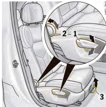
図77: 機械式シートの調節
