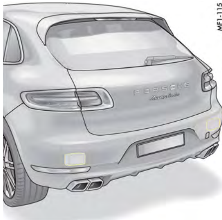
図300: リヤ・バンパー内のレーダー・センサー
