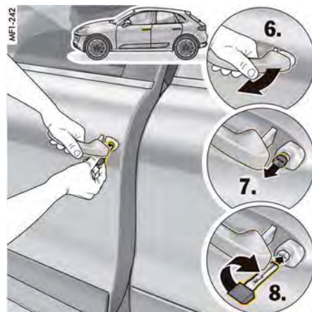
図122: 運転席ドアの緊急ロック
