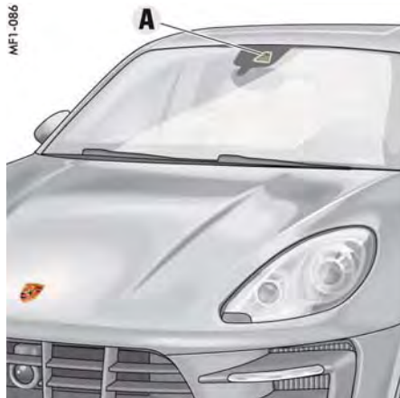
図107: カメラの取り付け位置
