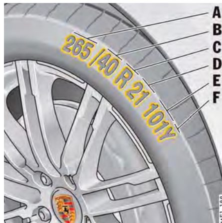
図125: ラジアル・タイヤの見方
