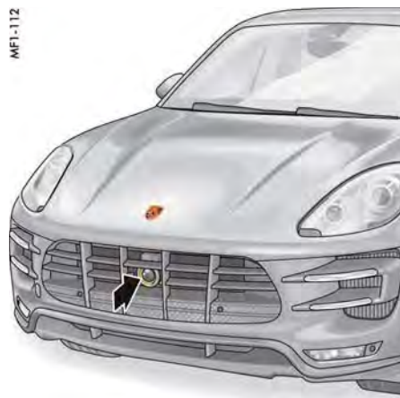
図1：レーダー・センサーの取り付け位置
