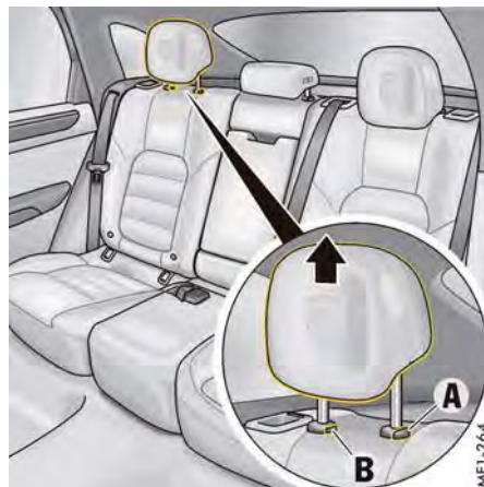
図82: リヤ・シートのヘッドレストの取り外しと取り付け
