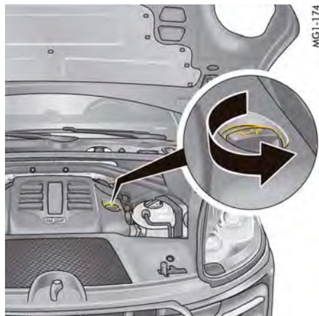
図43: Macan S Dieselのオイル給油口
