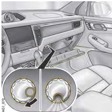
図37: グローブ・ボックスの冷却
