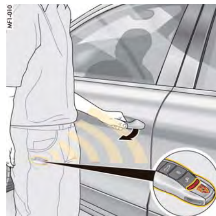
図114: ポルシェ・エントリー & ドライブによるドアのロック解除
