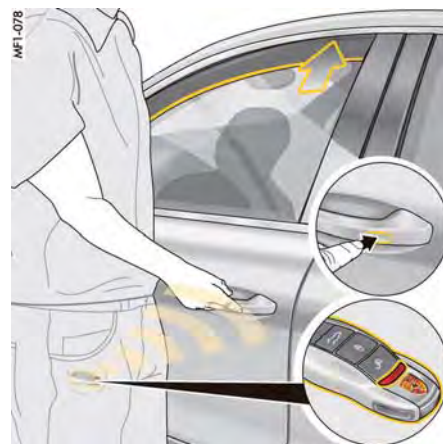
図19: ドア・ハンドルのタッチ・センサーでウィンドウを閉じる (ポルシェ・エントリー & ドライブ 装備車)
