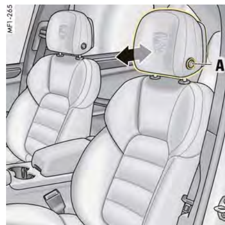
図80: フロント・シートのヘッドレストの前後位置調節
