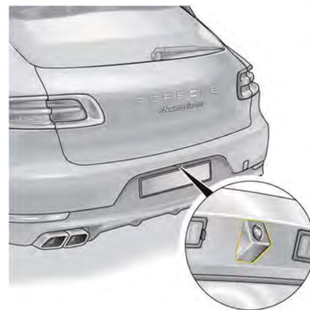
図164: リヤビュー・カメラはバンパーのライセンス・プレート・ライトの間に取り付けられています。
