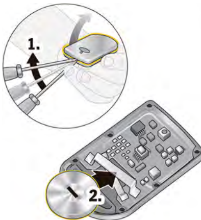
図235: ドライバー・カード用電池の交換
