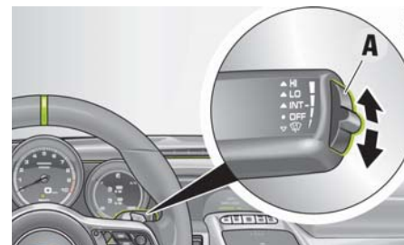
レイン・センサー作動感度のスイッチ(A)
